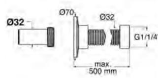
RACCORDO Joint flexible Ablaufverbindung für wandgebundene Standwaschtische, Verbindung vom Ablaufventil zum UP-Siphon
